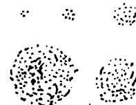
Fig. 2. Sekundärteilchen (Polyone) verschiedener Größe aus kleinen Primärteilchen (Protone).
